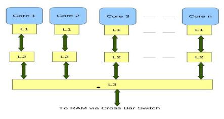
Figure 2 AMD<sup>TM</sup> Multicore Architecture
