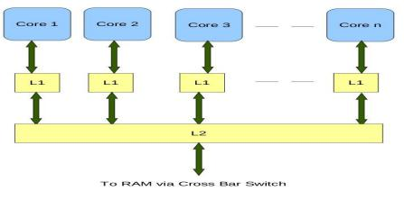
Figure 1 INTEL<sup>TM</sup> Multicore Architecture
